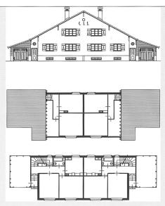
Plan type du rez-de-chaussée et du 1er étage, ainsi que de l'élévation côté rue, dessinés d'après les tirages d'époque
