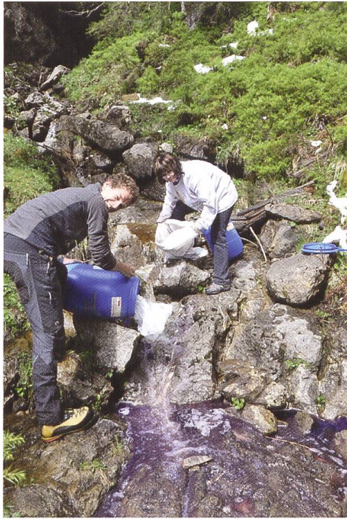
Abb. 2: Färbung mit Naphtionat, einem optischen Aufheller für Textilien. (Foto C. Seiler)
