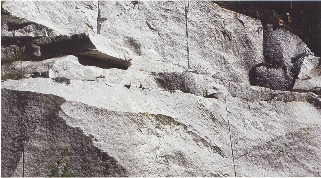
Abb. 26: Im Steinbruch Chüenzetännelen an der Grimsel werden grosse Blöcke aus dem anstehenden Felsen gesprengt. Da Granit nicht lagig vorkommt, können die Grösse und die Form der Stücke im Voraus nur unbedeutend beeinflusst werden. (Foto: Alfred Hänni)
