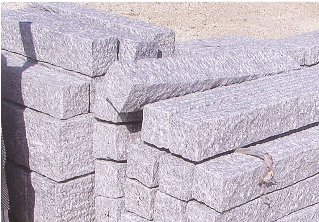
Abb. 23: Für den ganzen Umfang der Kirche dürften zirka 90 Laufmeter Sockelsteine erforderlich gewesen sein – eine enorme Menge! (Werk-Foto, mit freundlicher Genehmigung der Fa. Schmid AG, Affoltern am Albis)
