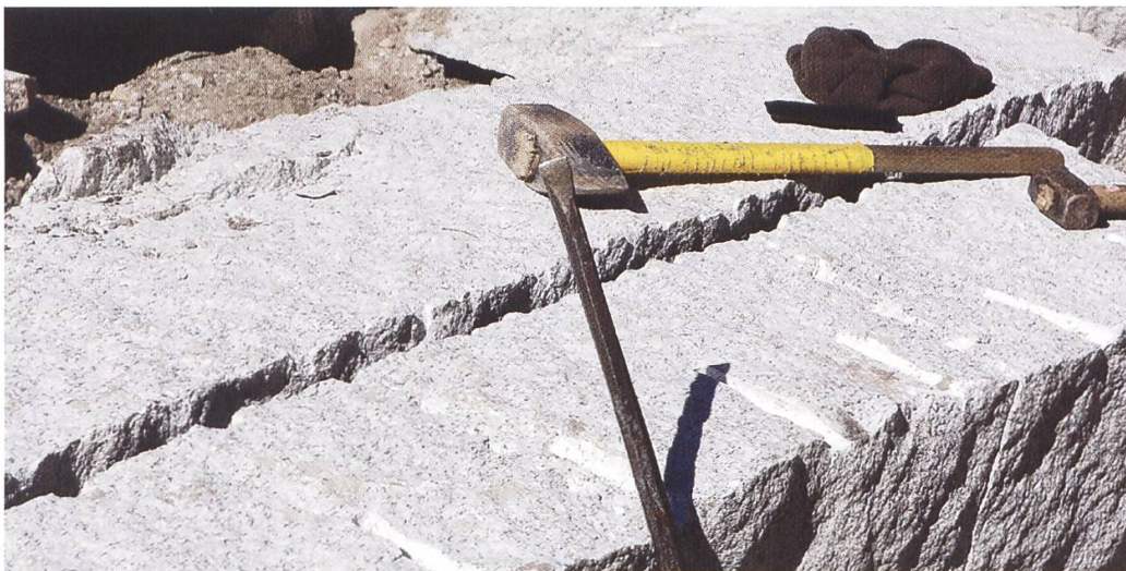
Abb. 27: Auf einem abgesprengten Granitblock wird zuerst auf einer Linie im Abstand von zirka 20cm ein Loch gebohrt. In jedes dieser Löcher wird ein Keil (ein Meissel) eingesetzt. Die Keile werden dann nacheinander immer tiefer in den Granit eingeschlagen, bis sich der Block auf der ganzen Länge spaltet. (Foto: Alfred Hänni im Steinbruch Chüenzetännelen an der Grimsel)
