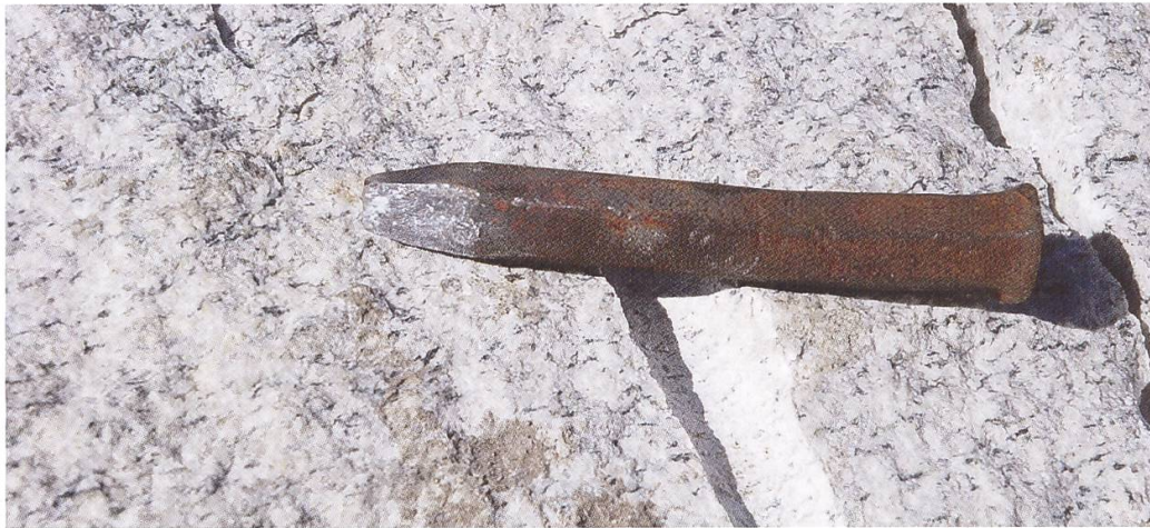
Abb. 28: Mit solchen Keilen (Meisseln) werden die Granitblöcke entlang der vorgebohrten Löcher gespalten. (Foto: Alfred Hänni)
