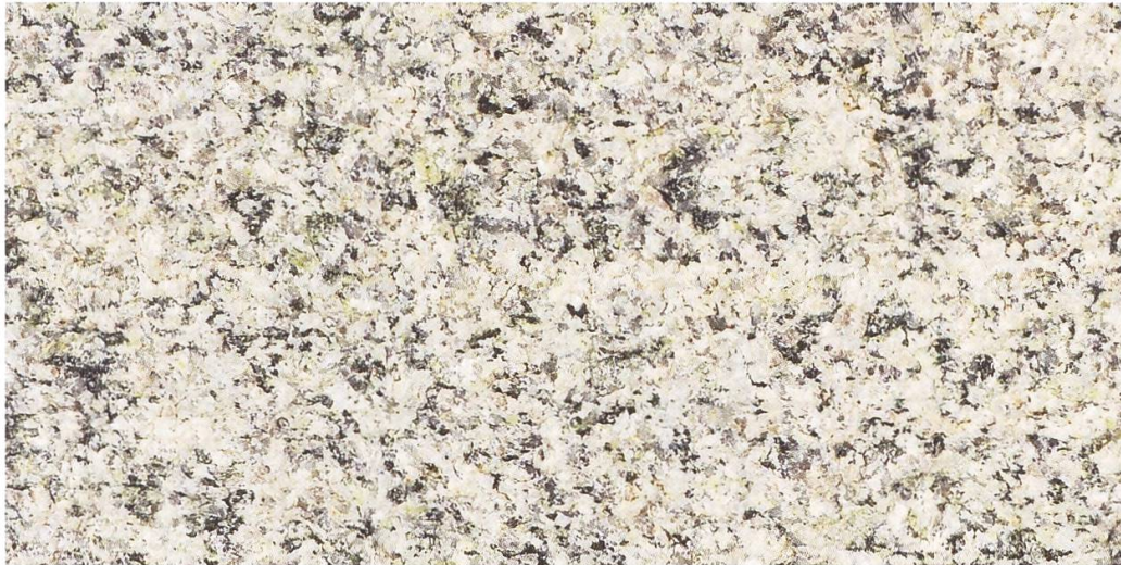
Abb. 20: Nahaufnahme des Granits der Sockelsteine mit einer feinen kristallinen Struktur. Wegen der Schwierigkeiten in der Bearbeitung des Granits blieben von den Findlingen schliesslich nur noch abgespaltene «Schroppensteine» und Schotter übrig (Foto: Alfred Hänni).
