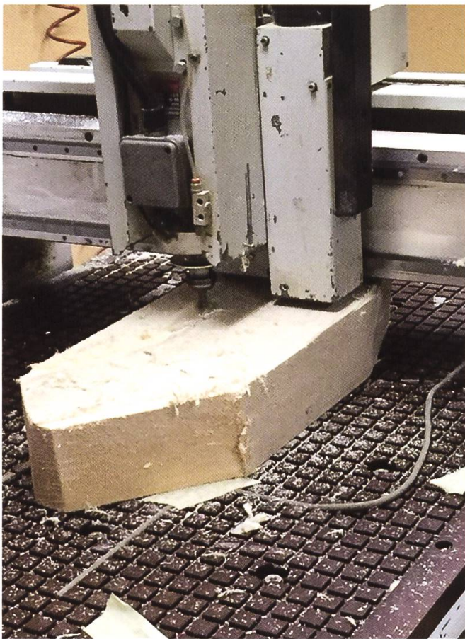
Abbildung 9: Ausfräsen der Innenform eines Alphornschaallbechers mit einer CNC-Fräse (Foto: Till Aerni)
