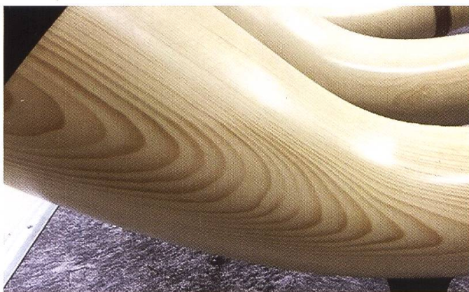
Abbildung 8: Krummschäftigkeit im Holz, auch genannt «Buchs» (Foto: Till Aerni)
