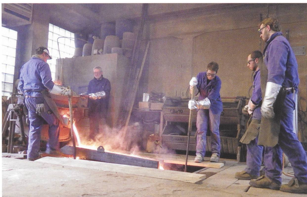
Der erfahrene Giesser Roland Bolliger, sein Lehrling und seine Gesellen leiten die glühende «Glockenspeise» über einen Kanal zur Giessgrube.
