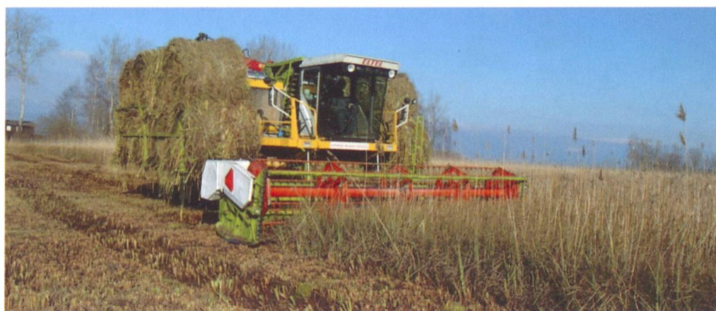
Figure 5: La faucheuse Elbotel dispose d'un train de chenilles larges (1 m 20), permettant d'exercer une pression faible au sol (moins de 300 g/cm 2 ). Elle est équipée d'un peigne de coupe de 6 m de largeur, d'une presse à balles, et de passerelles latérales permettant de stocker 22 balles de paille d'un poids moyen de 300 kg. A plein, le poids total de la machine est de près de 30 t. La machine présentée sur la photo est la 3 e évolution de Elbotel, depuis sa création en 1984. (Photo: collection Grande Cariçaie)
