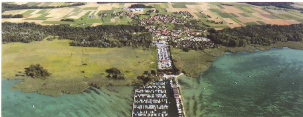
Figure 4: Exemple d'atteinte aux zones naturelles par des infrastructures touristiques: le port de Chevroux (VD) est construit essentiellement sur la beine lacustre. Le parking en arrière a lui été réalisé par remblais sur les marais. Il crée aujourd'hui un effet de coupure entre les zones naturelles situées de part et d'autre. On distingue encore à l'arrière-plan, à droite, une zone de camping et de résidences secondaires, elle-aussi construite sur d'anciens milieux humides asséchés. (Photo: Paysagegestion)
