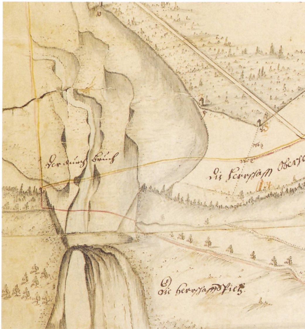
Ausschnitt aus Samuel Bodmer (1717): «Plan und Grund Riss von dem Kander ...». Der ausgeweitete Stollen mit darüberliegendem Aushub kurz vor dem Einsturz
