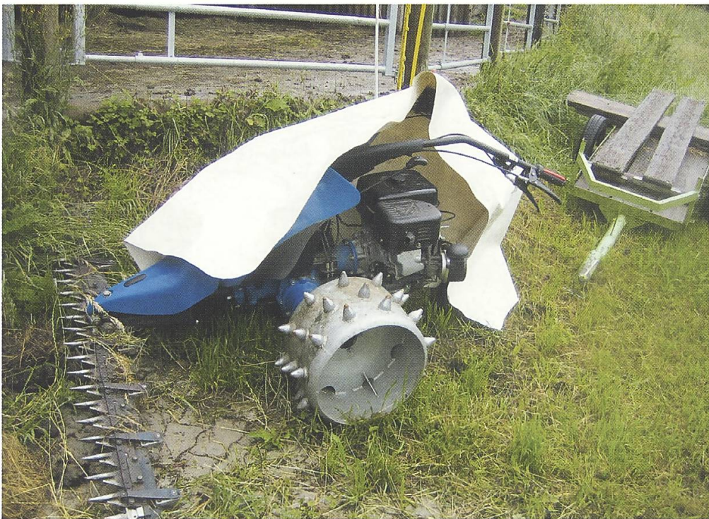
Balkenmäher mit Stollenantrieb, geeignet für steile Hänge
