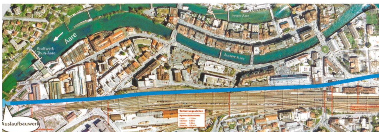
Abb. 3: Entlastungstollen: Situation (Quelle: IC)
