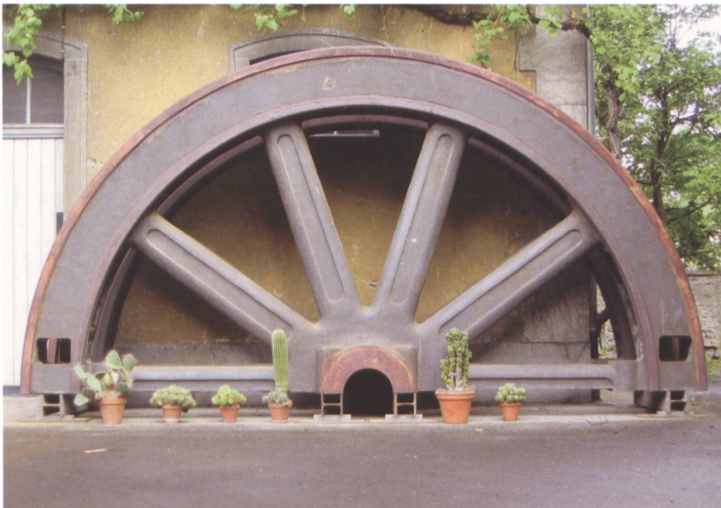
Allein das Schwungrad der grössten Dampfmaschine wiegt über 20 Tonnen
