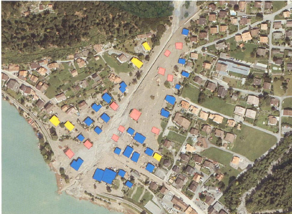
Abb. 7: Der Murgang des Glyssibaches vom 23. August 2005 mit den zerstörten (rot), den beschädigten (blau) und den leicht beschädigten (gelb) Gebäuden (Abt. Naturgefahren 2004)
