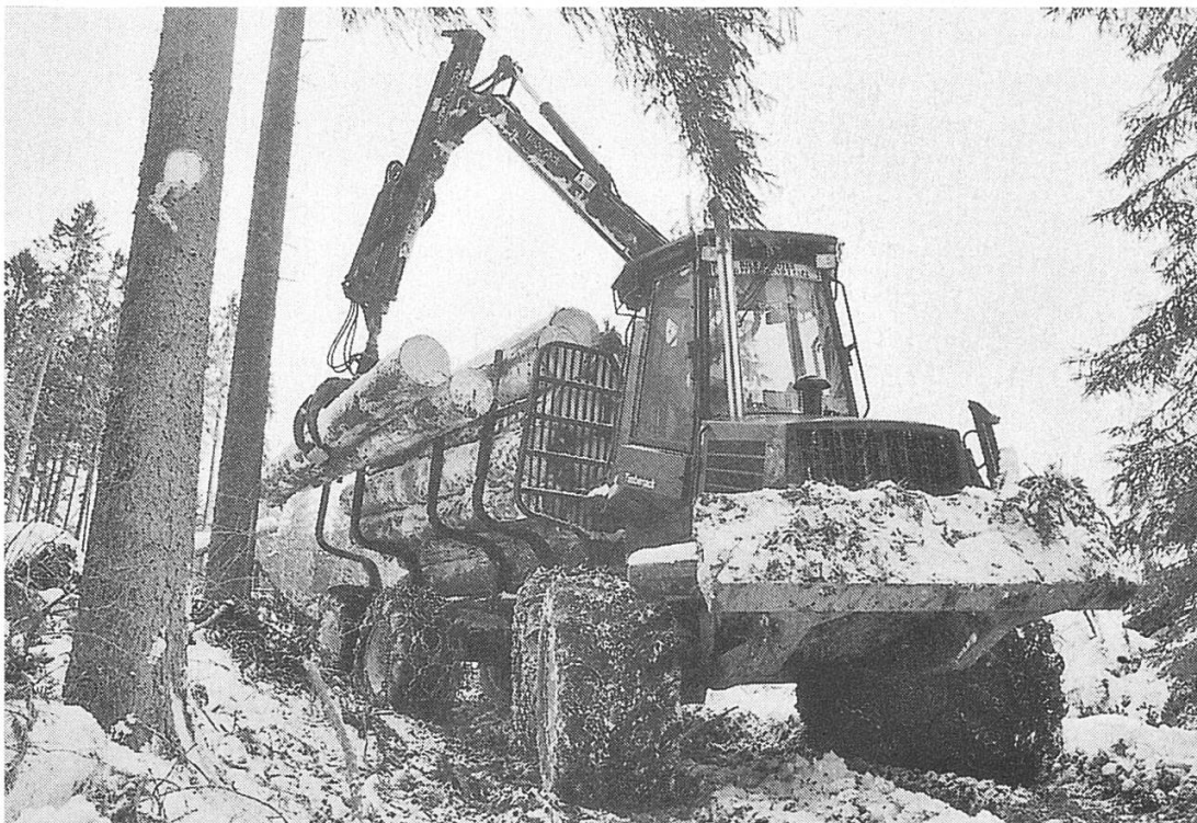
«Forwarder» sind die neuen Rückefahrzeuge, die in befahrbarem Gelände die abgelängten Stämme an die Abfuhrwege befördern. (Fotos: Forstbetrieb Sigriswil)
