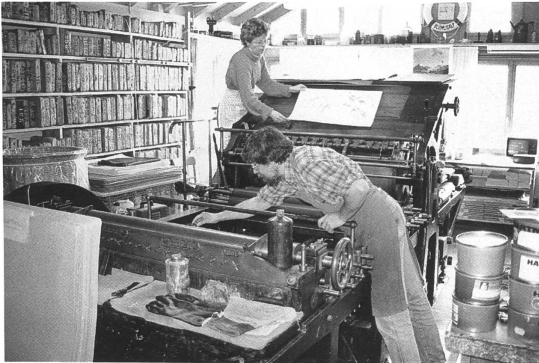
Aufstreichen von Farbe und Einlegen der Druckbogen in die Schnellpresse.
