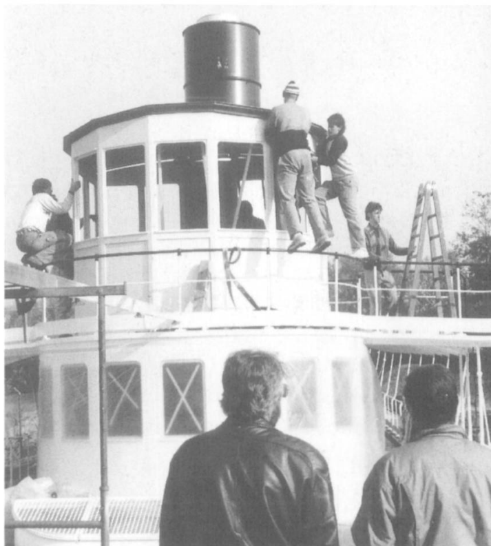
Abb. 16: Lehrlinge der Lehrwerkstätte Bern montieren das von ihnen erbaute Ruderhaus.
