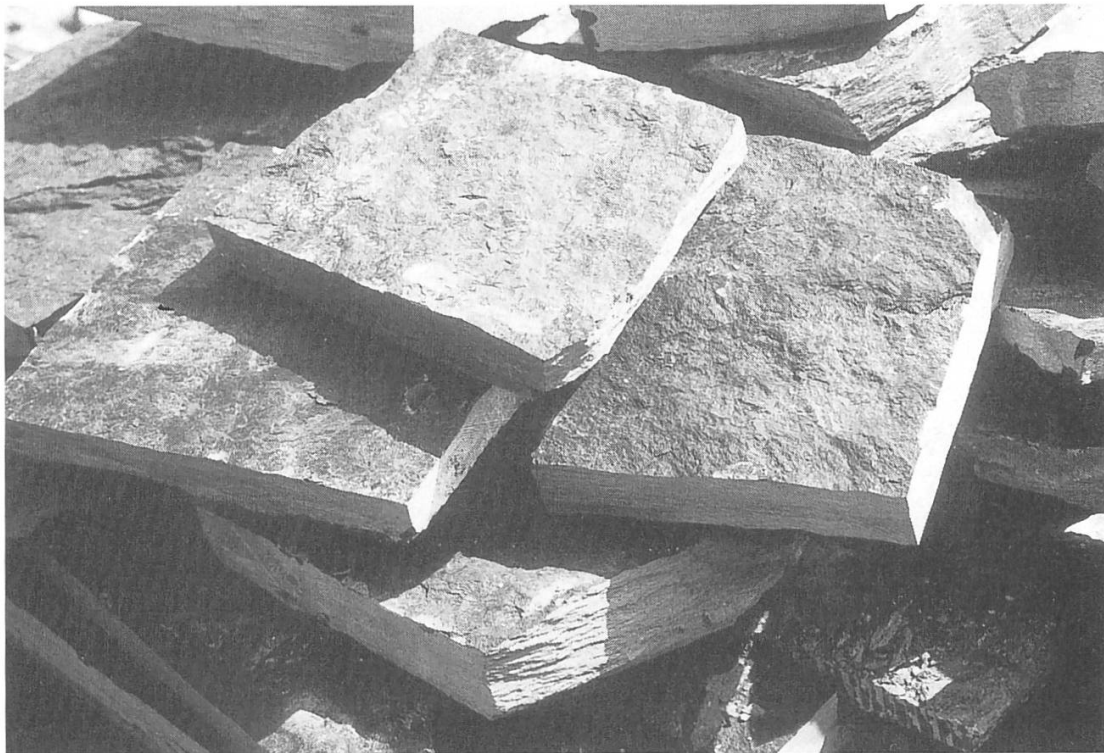
Bild 22 Zurechtgesägte Goldswiler Platten (Ringgenberg 1987).
