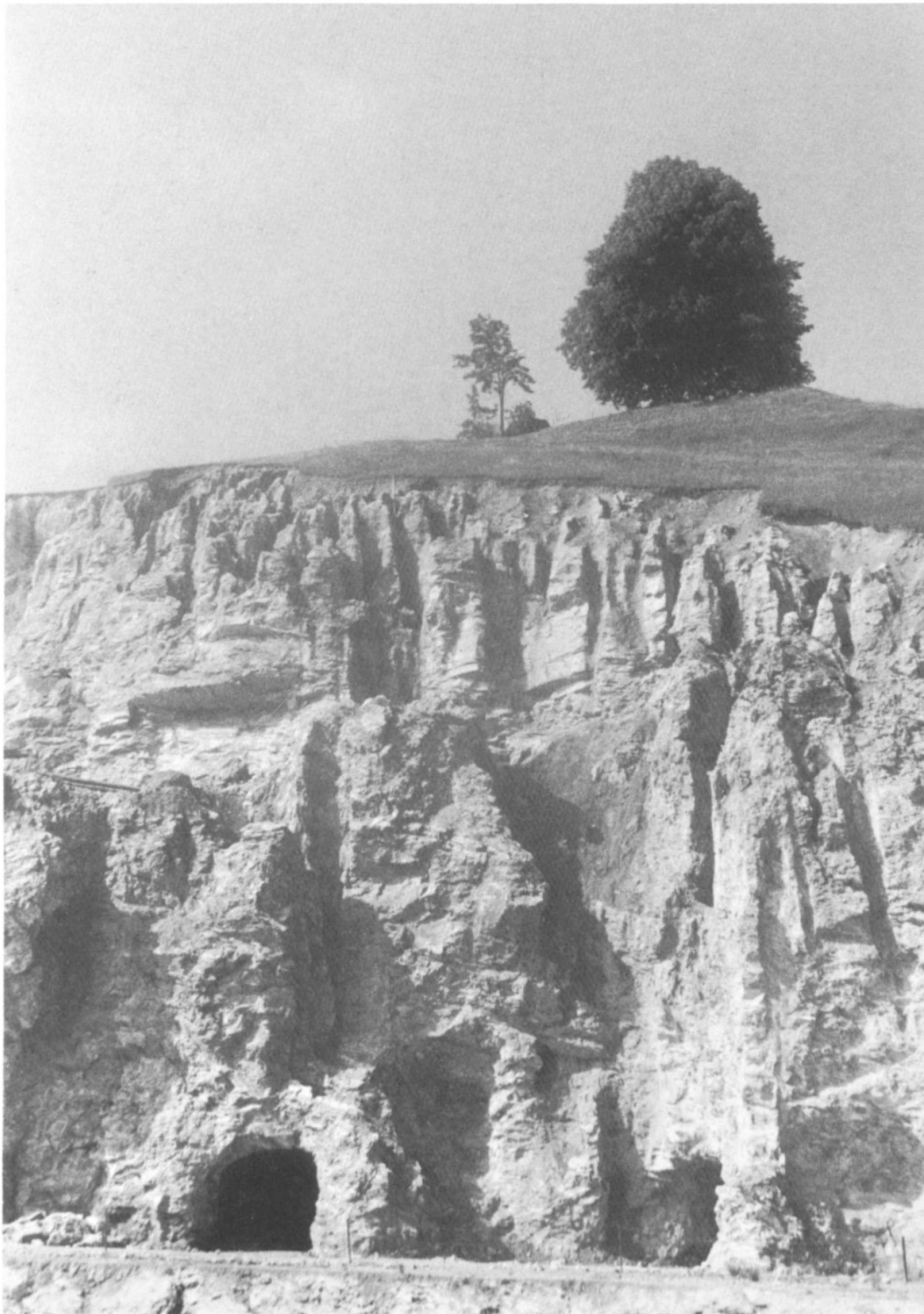
Anschnitt des zerklüfteten Gipses mit karrenförmiger Oberfläche im Steinbruch. Stollen- vortrieb zu den Lösungsschlotten, welche von unten her vom Glazialschutt entleert werden.
