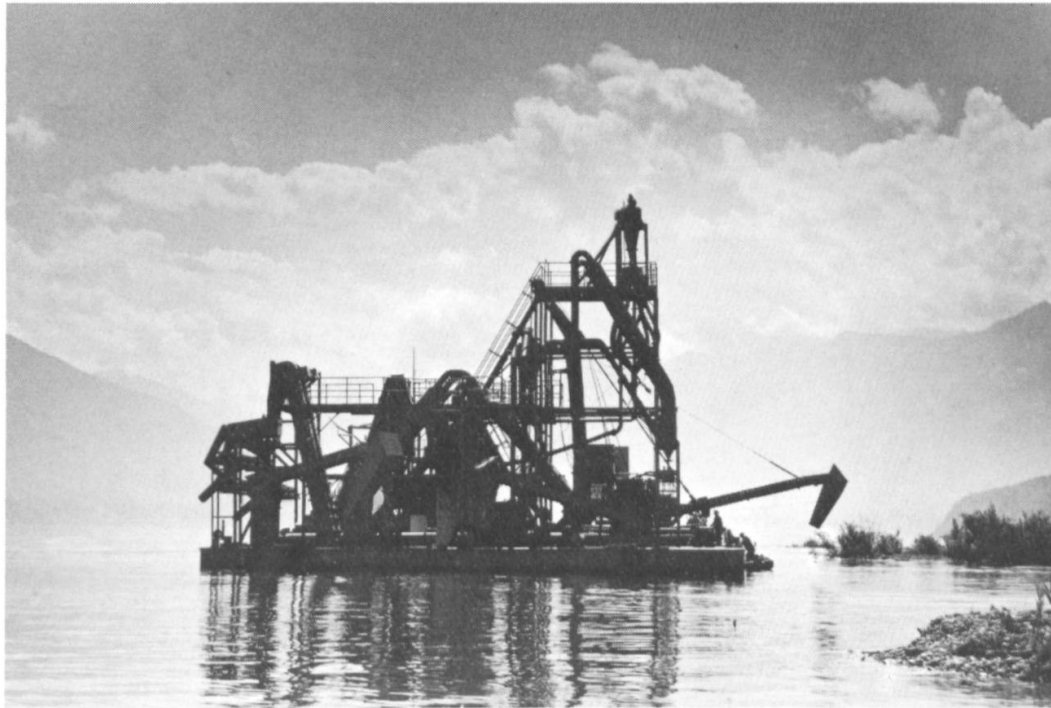
Abb. 3: Das schwimmende Kieswerk mit den 6 Lavodunes, welches Kies und Sand nach neuester Art klassiert, seit 1963 im Betrieb.
