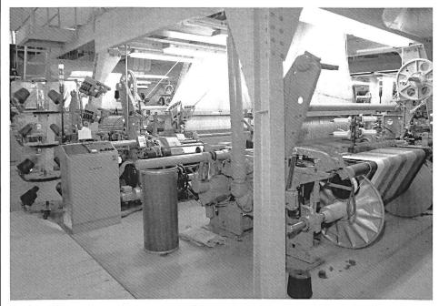
Die Weberei in Heerbrugg verfügt über vier neue Dornier Jacquard GTV 16J mit einer in eigener Regie konstruierten 16-Farben-Schussaufsteckvorrichtung.
