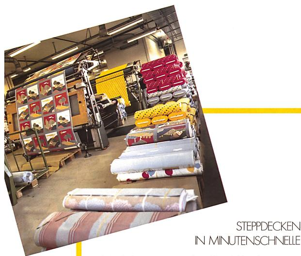
Auch in der Stepperei ging man modernste Wege. Auf der vollautomatisierten, computergesteuerten Steppmaschine werden mit minimalem Zeitaufwand gesteppte Decken, Schlafsäcke, Polsterdecken für Möbelgestelle und Gartenkissen gefertigt. Bis zur perfekten Abheftung erfolgt alles automatisch.
