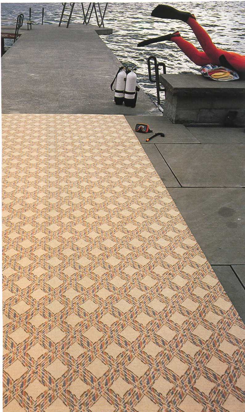
Alpina-Création: Wilton-Velours, 3-chorig gewebt. Originalbreite 200 cm. Polhöhe ca. 7 mm. Noppendichte ca. 98 000 Noppen/m 2 (ca. 196 000 Einzelschenkell/m 2 ). Rückenbeschichtung: leitfähige Appretur.
