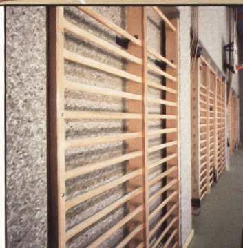
Lehnsturnhallen Winterthur: 2500 m 2 Kugelgarn-Belag «Pamir», Kolorit «Wiesel», verlegt als Wandverkleidung. Nutzschicht 40% Schurwolle, 35% Polypropylen, 25% Schurziegenhaar. Einsatzgewicht ca. 950 g/m 2 . Gesamtdicke ca. 7,5 mm. Latexierter Federrücken.
