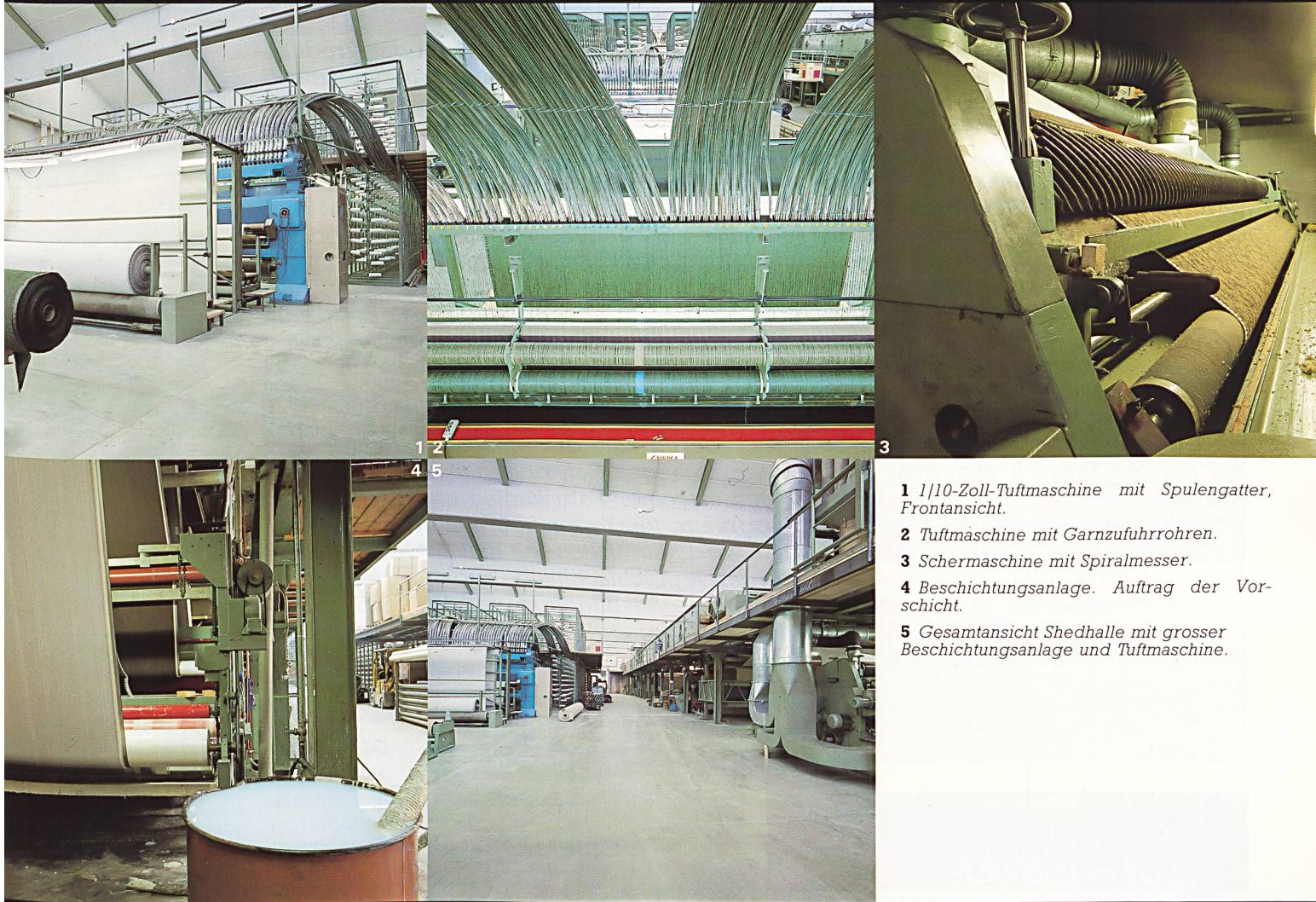
**1** 1/10-Zoll-Tuftmaschine mit Spulengatter, Frontansicht.
