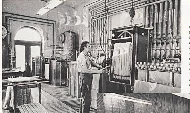
In der hauseigenen Färberei wird ein grosser Teil der Garne für die Möbelstoffherstellung eingefärbt / Une bonne partie des fils pour la fabrica-tion de tissus d'ameublement sont teints à l'atelier de teinture de l'entreprise | A large part of the yarns for the production of furnishing fabrics is dyed in the firm's own dyeing works / Gran parte dei filati destinati alla produzione di tessuti per mobili è tinta nella tintoria aziendale.
