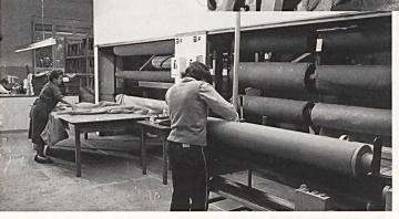
Die neue Pater-Noster-Anlage mit automatischem Schneidetisch. La-gerkapazität über 300 Rollen bzw. 10 000 Meter / La nouvelle installa-tion paternoster avec table de coupe automatique. Plus de 300 rouleaux de capacité, c'est-à-dire 10 000 mètres / The new Pater-Noster plant with automatic cutting table. Storage capacity: over 300 bolts or some 10,000 meters / Il nuovo impianto Pater-Noster con tavalo di taglio automatizzato. La capacità del deposito è di 300 rotoli risp. 10 000 metri.
