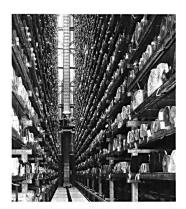
Manuell gesteuertes Regalbediengerät im Stoffrollenlager in Langenthal.
