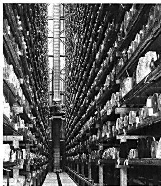
Manuell gesteuertes Regalbediengerät im Stoffrollenlager in Langenthal.
