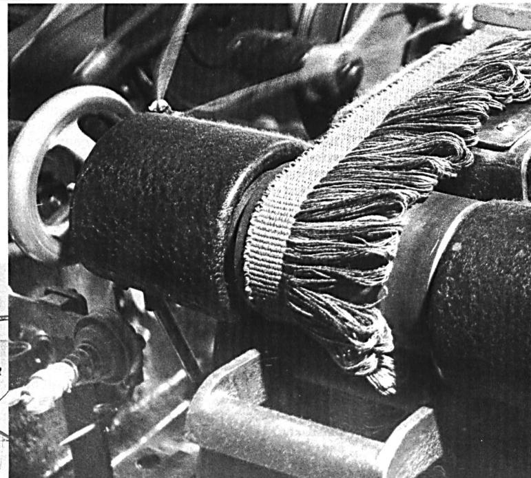
△ Die Herstellung von Fransenborten wird maschinell betrieben, doch können auch hier die Farbzusammenstellungen beliebig oder nach Stoffvorlage vorgenommen werden / The production of fringed borders is performed mechanically, but here too the colour combinations can be made as desired or according to the fabric model.
