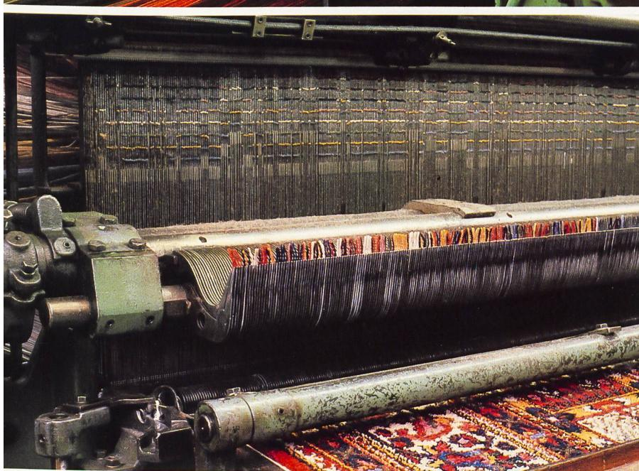
Die Herstellungstechnik dieser Spezialteppiche geschieht nach dem Gripper-Axminster-Prinzip. Für jeden Farbpunkt in der Vorlage wird das entsprechende Garn mit dem Greiferschnabel in den Teppich eingeführt und dort – mit zwei Ober- und einem Unterschuss – von zwei sich kreuzenden Bindkettfäden eingewebt.
