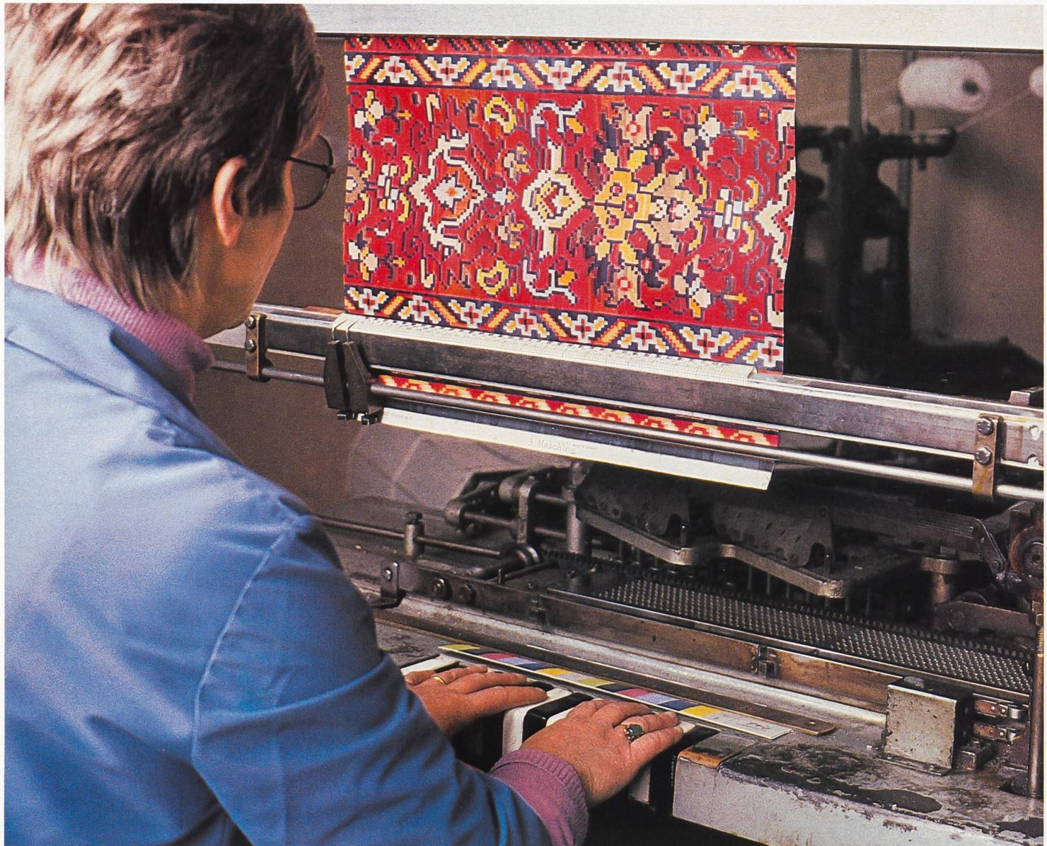
Beim Kartenschlagen wird minuziös Linie um Linie abgelocht, damit später die Jacquardmaschine fehlerlos gesteuert wird und die überlieferten Muster des Originals authentisch in den Teppich eingewoben werden.
