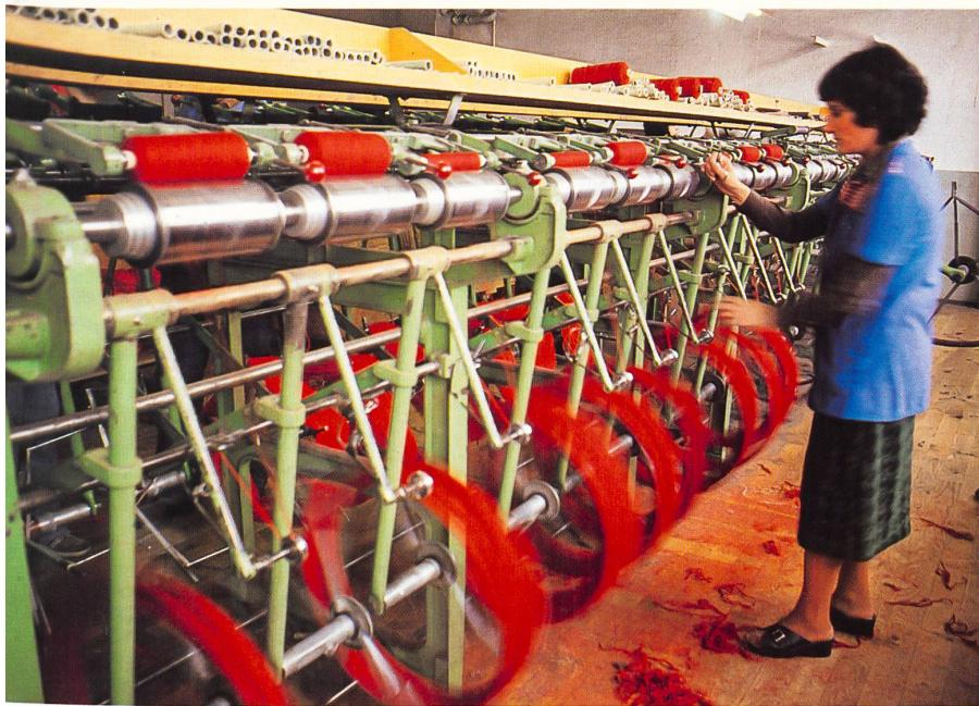
In der Spulerei werden die einfachen Fäden zu Dreifachgarnen vereint und auf die Spulen gewickelt. Die Grösse der Spule richtet sich nach dem Farbanteil des gewobenen Teppichs.
