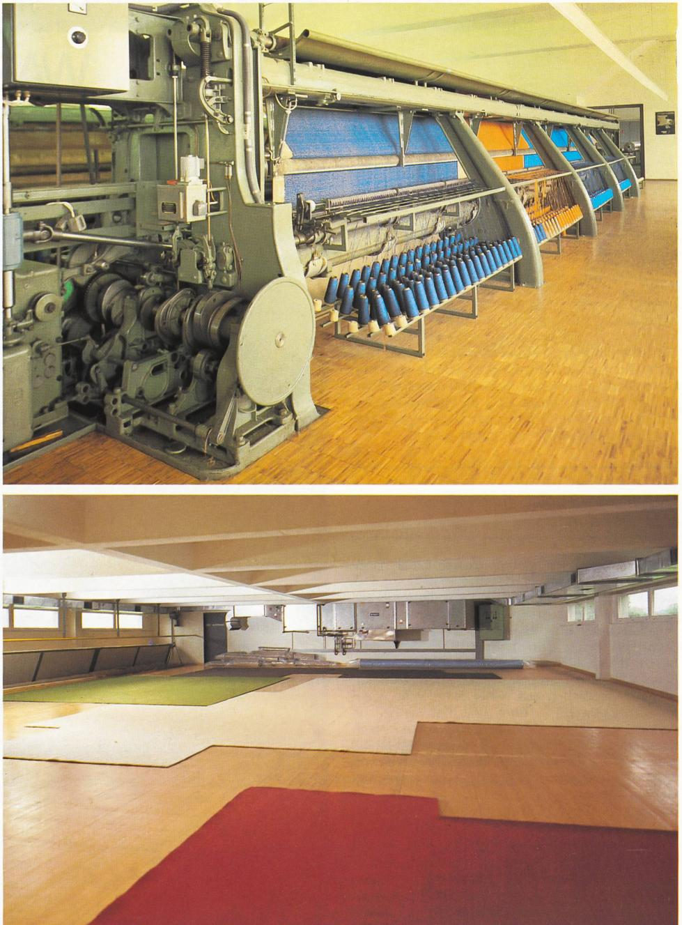
Die elektronisch gesteuerte Teppichmaschine, auf der bis zu 13,5 Meter breite Ware hergestellt werden kann • Métier à tapis à commande électronique, qui peut produire des articles jusqu'à 13,5 mètres de largeur • The electronically controlled carpet machine which can produce widths of up to 13.5 metres • La macchina per tappeti con direzione elettronica, capace di produrre articoli fino a 13,5 m di larghezza.
