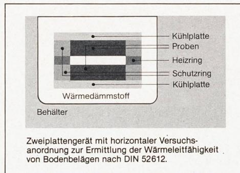
Zweiplattengerät mit horizontaler Versuchsanordnung zur Ermittlung der Wärmeleitfähigkeit von Bodenbelägen nach DIN 52612.
