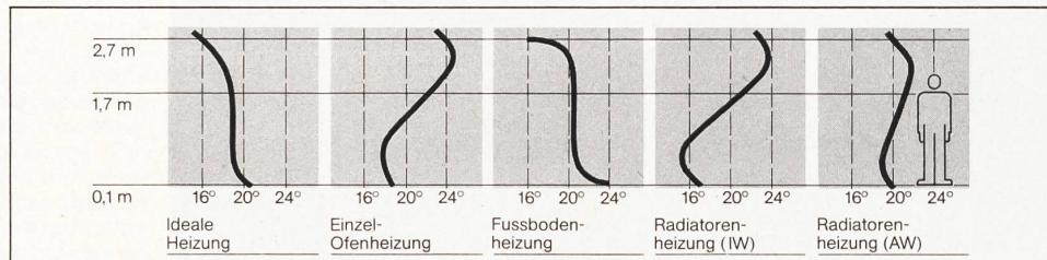
Vereinfachte Raumtemperatur-Profile als Grundlage zur wärmephysiologischen Bewertung verschiedener Heizsysteme nach Dr. A. Kollmar. Es zeigt deutlich: Das Profil der Fussbodenheizung entspricht als einziges praktisch demjenigen der als ideal bewerteten Heizung.
