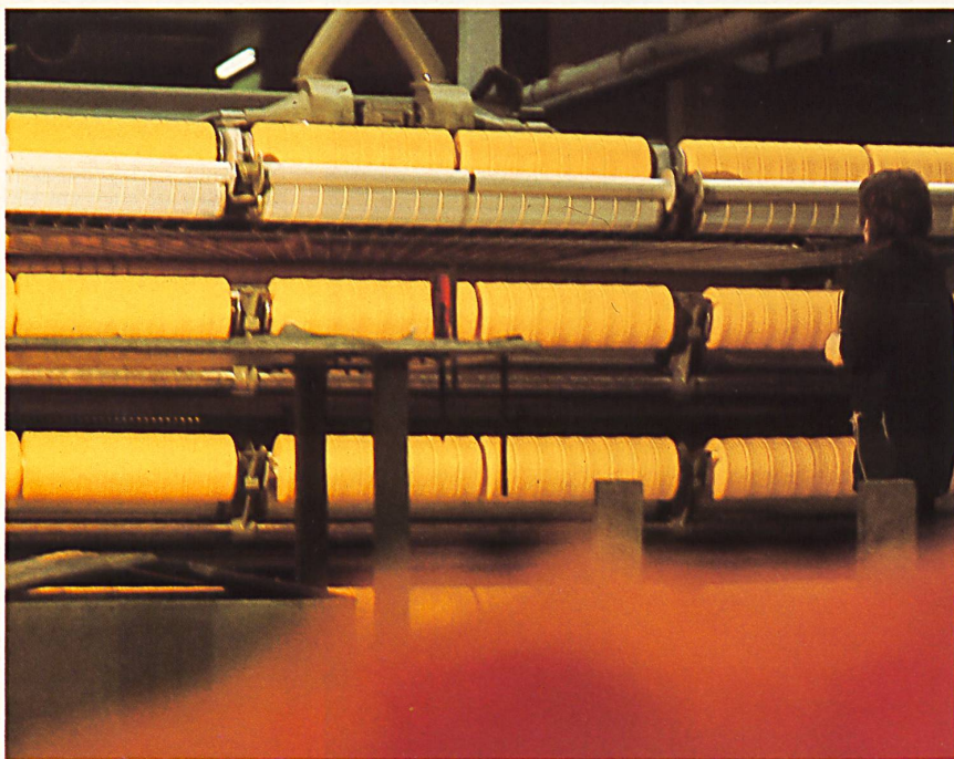
Hochleistungskrempel, Vorbereitungsmaschine für Streichgarne / Carde à grande capacité pour la préparation des filés cardés / High-speed carding machine, machine for the preparation of carded yarns / Macchina di alto rendimento per la preparazione dei filati cardati.
