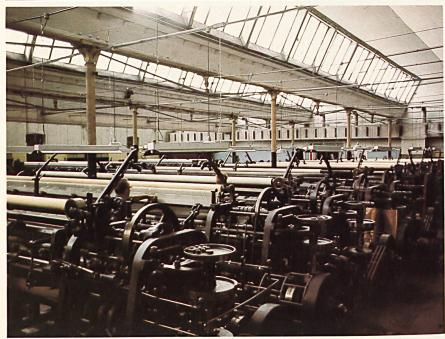
$\Delta$  Handspannrahmen / Cadre d'extension à la main / Hand-stretching  $\Delta$  frame / Telaio per tendere a mano.
