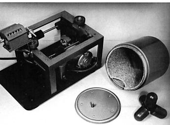
Tetrapod-Walker-Maschine zur Beurteilung der Strapazierfähigkeit. Der mit Gummifüssen versehene Vierfuss wird in die mit dem Teppich ausgelegte Trommel gelegt. Im Bild ist der Treppenabsatzeingebaut. Nach vierhunderttausend Umdrehungen wird der Teppich bezüglich Abnützung beurteilt. In diesem Gerät lassen sich auch Anschmutzversuche durchführen.
