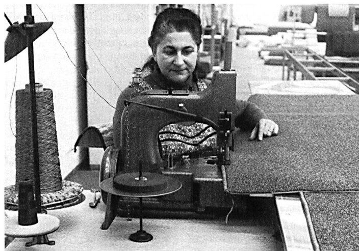
Kurbelmaschine zum Einfassen der zugeschnittenen Teppiche
