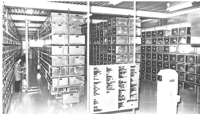
Colour-yarn depot with 2200 aluminium containers Buntgarnlager mit 2200 Aluminiumbehältern
