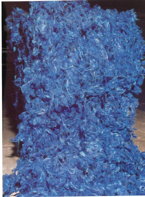
Fasermischung, bereit zur Speisung der Vlieskrempel
