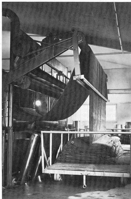
Auslaufen der gefärbten Ware aus der Färbemaschine
