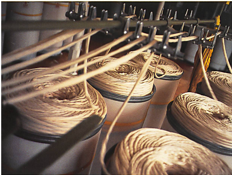
Parallelisieren der Fasern
