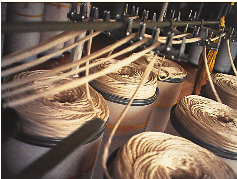
Parallelsieren der Fasern
