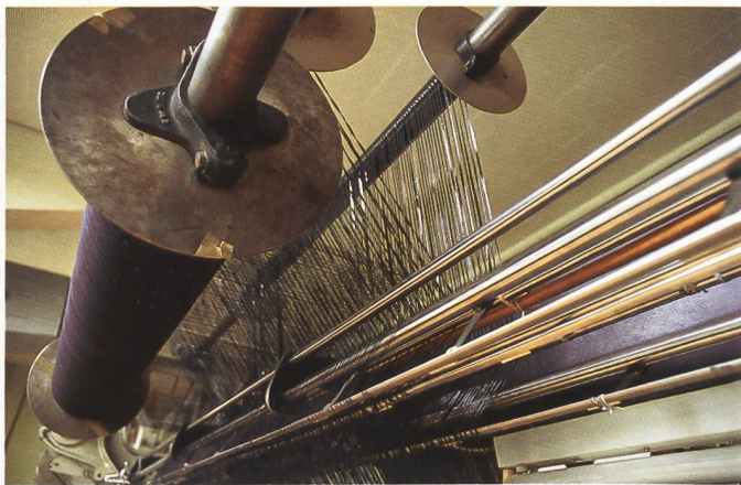
Raschelmaschine von ca. 1970 mit Chenille
