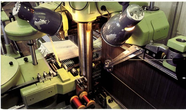
Stünzi – Einziehmaschine
