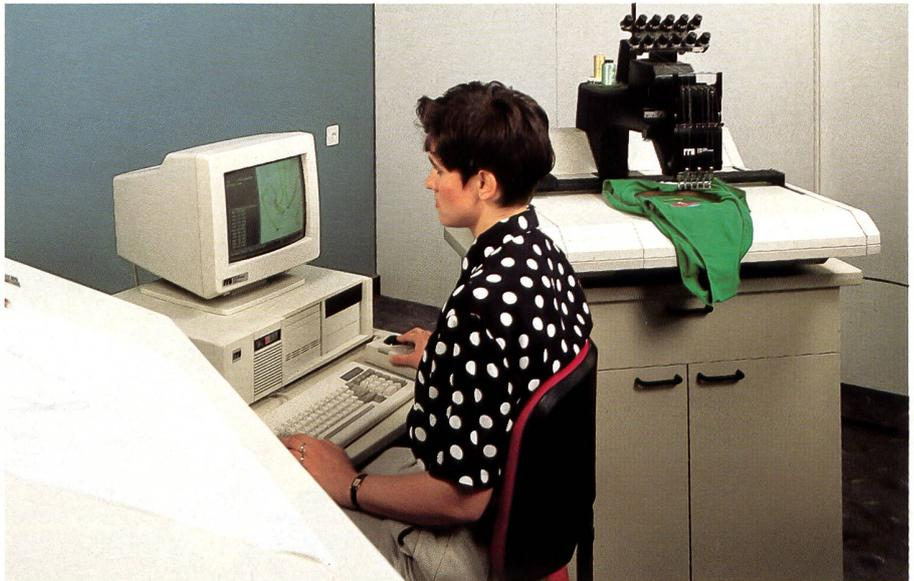
Punchanlage mit EMC6-Stickmaschine
