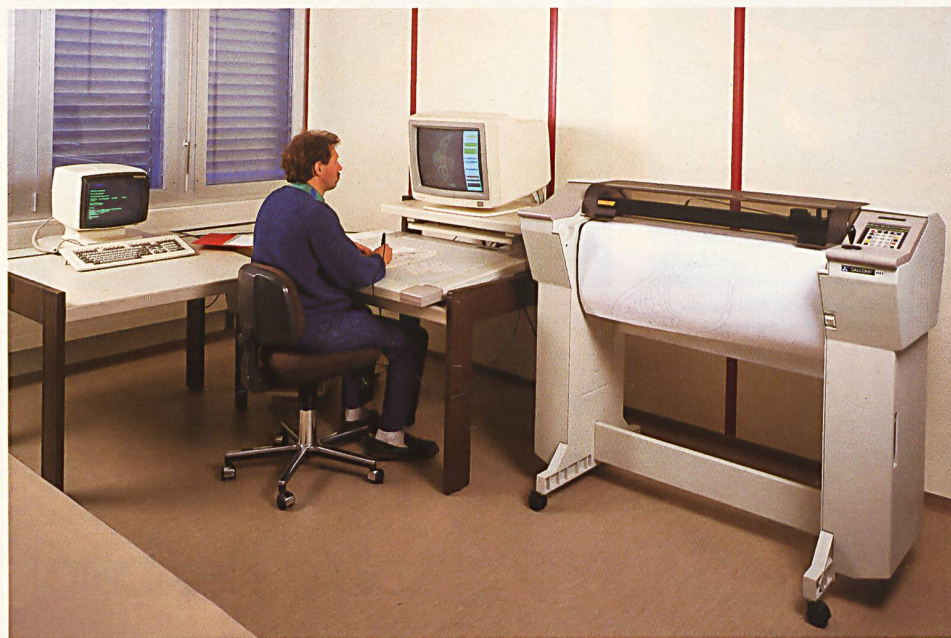
Elektronische Zeichnungsanlage Saurer «atelier/artist». Die Entwürfe werden mit dem Digitalisierstift erfasst, vom Computer verarbeitet, und schliesslich erstellt der Mehrfarbenplotter die technische Stickerezeichnung.
