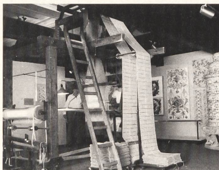
Mit diesem alten Jacquard-Handwebstuhl können pro Tag 5 bis 8 cm Seidenstoff gewebt werden. Ein Glockenbimmel macht den Weber auf Farbwechsel aufmerksam.
