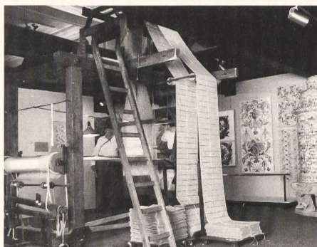
Mit diesem alten Jacquard-Handwebstuhl können pro Tag 5 bis 8 cm Seidenstoff gewebt werden. Ein Glockenbimmeln macht den Weber auf Farbwechsel aufmerksam.
