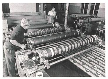
Rundfilmdruckmaschine zum Bedrucken von Geweben und Maschenwaren.
