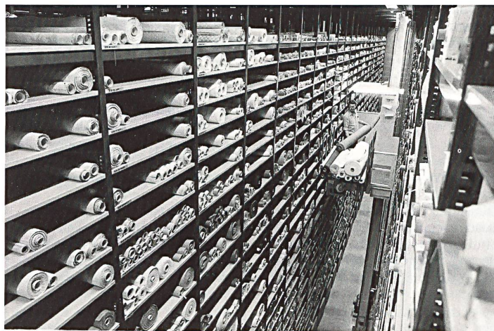
Fisba-Zentrallager Winkeln: modernes Hochregallager mit 4 Schluichten und 8 Regalreihen, die eine Länge von 34 m und eine Nutzhöhe von 10 m aufweisen.
