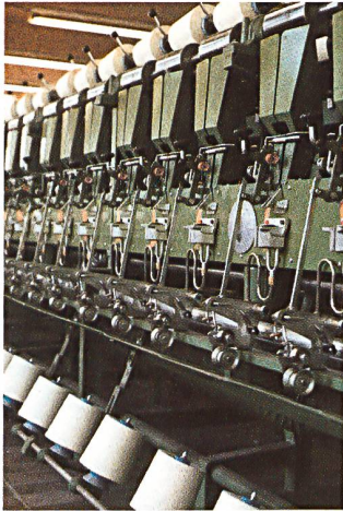
Gasieren: Abbrennen der abstehenden Baumwollfasern zwecks Erzielung einer glatten, glänzenden Oberfläche auf dem Baumwollzwirn
