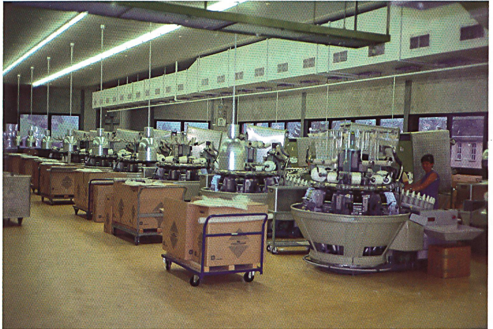
Spulerei-Abteilung mit Schweizer CA11 Maschinen / Section de canetage, machines Schweizer CA11 / Winding section with Schweizer CA11 machines.
