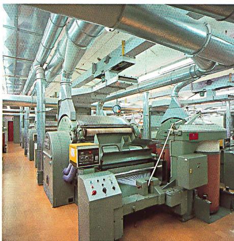
Rieter Aerofeed-F Kardenanlage / La carde Rieter Aerofeed-F / The Rieter Aerofeed-F carding machine.
