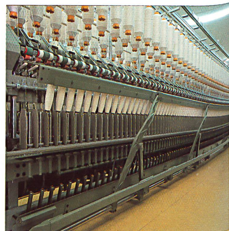
Doffingautomat bei Rieter Spinnmaschinen / L'automatisme doffing des machines à filer Rieter / Automatic doffing with Rieter spinning machines.
