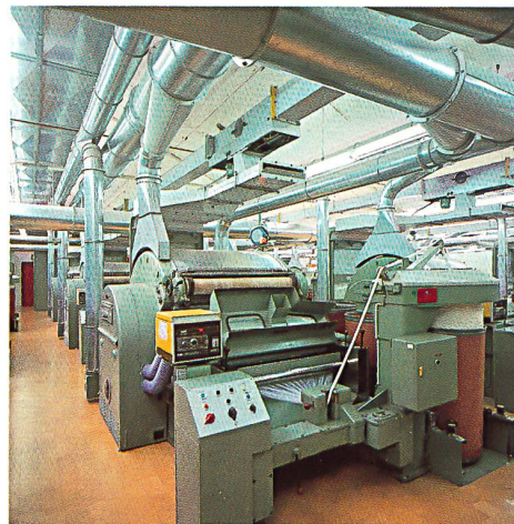
Rieter Aerofeed-F Kardenanlage / La carde Rieter Aerofeed-F / The Rieter Aerofeed-F carding machine.
