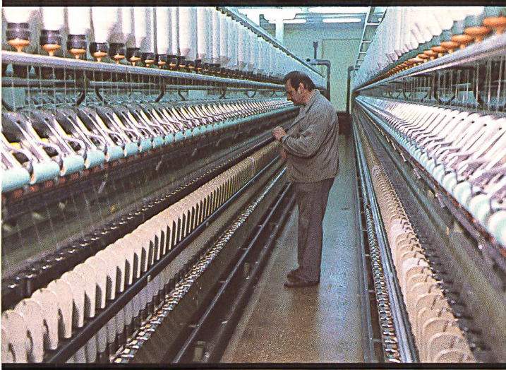
Im Ringspinnsaal Spinnerei Dietfurt / Vue de l'atelier de filature à anneaux de Dietfurt / In the Dietfurt Spinning Works ring-spinning hall.
