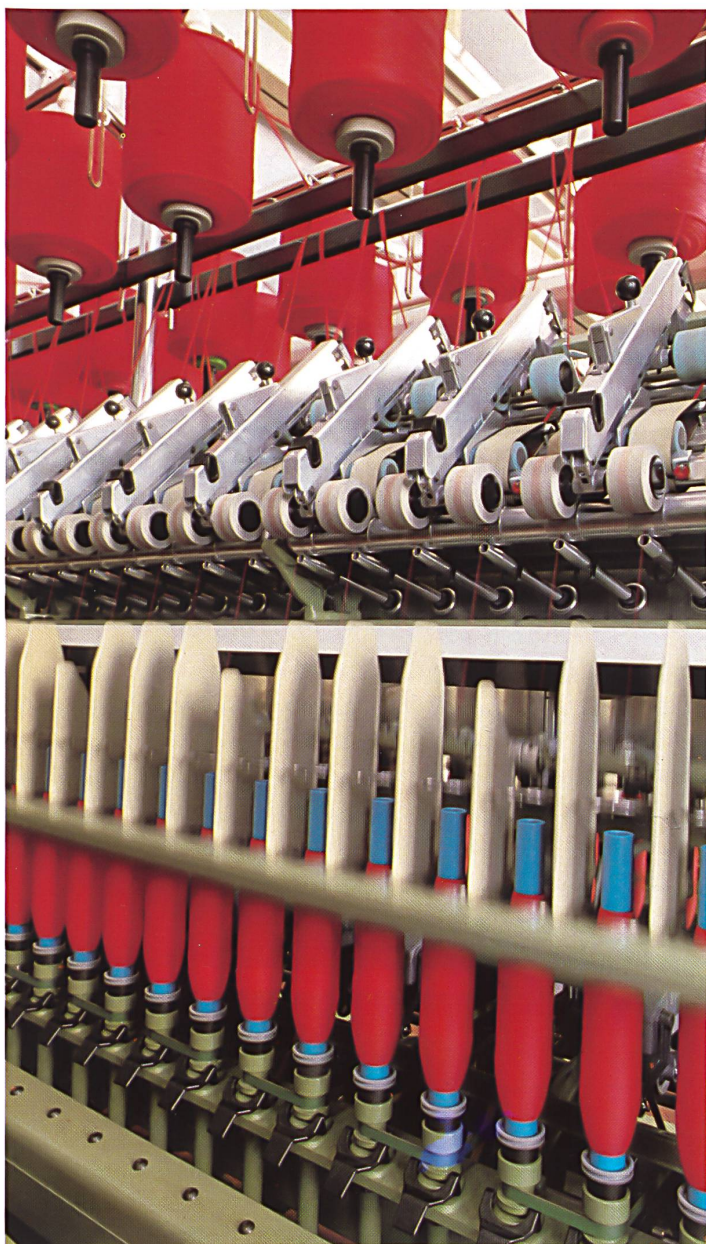
Das Herz der modernen Kammgarntspinnerei ist die Ringspinnerei.
