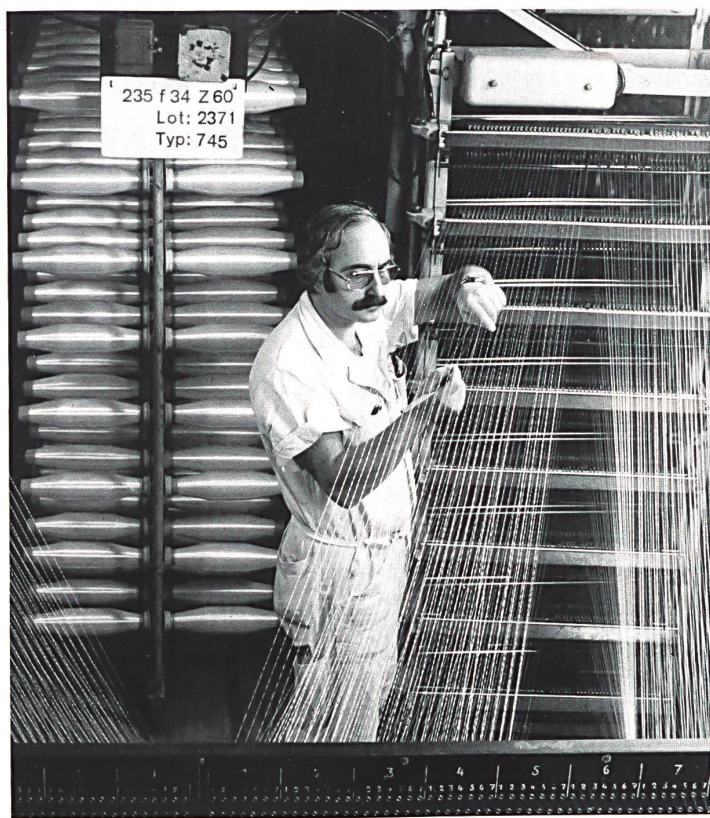
Auf modernsten Hochleistungs-Texturiermaschinen werden Nylsuisse Texturgarne für die Herstellung von Feinstrumpfwaren produziert. / Nylsuisse textured yarns for the manufacture of fine hosiery are produced on the very latest high-speed texturing machines.
