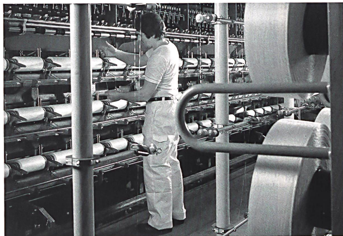
Auf modernsten Hochleistungs-Texturiermaschinen werden Nylsuisse Texturgarne für die Herstellung von Feinstrumpfwaren produziert. / Nylsuisse textured yarns for the manufacture of fine hosiery are produced on the very latest high-speed texturing machines.
