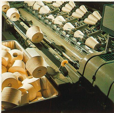
Auf Koniermaschinen modernster Bauart werden die Garnspulen fabriziert.
