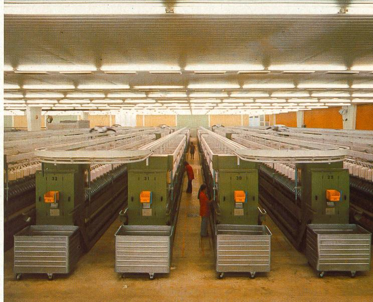
Die Ringspinnmaschinen sind mit Dofferanlagen zur automatischen Abnahme der Garncops ausgerüstet.
